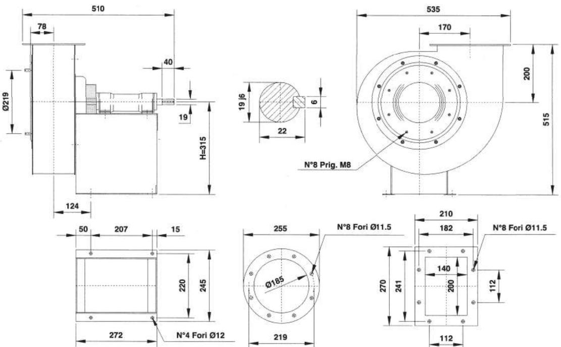
Orientamenti norme UNI ISO 13349 (viste lato trasmissione)
