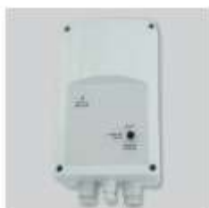
VAPZ Regolatore elettronico di tensione per ventilatore 230V 50Hz. Funziona in posizione AUTO in base a tre modalità di ingresso e limiti di tensione di uscita tra 80 e 230V.
