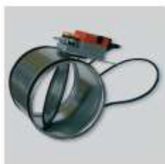
REMP Serrande motorizzate circolari con corpo in acciaio zincato e motorizzazione controllata da una sonda di CO 2 . Il servomotore funziona proporzionalmente al segnale 0-10V inviato dalla sonda. Intercalando il modulo BEAS si può ottenere la posizione minima e massima. Si utilizzano nei sistemi di ventilazione multizona di tipo proporzionale.
