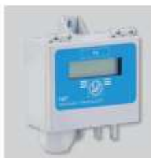
TDP-S/TDP-D/TDP-PI Sensori di pressione. Si utilizzano per Controllare la pressione nei sistemi di ventilazione a pressione costante. Permettono la lettura della differenza di pressione tra due punti e la trasformano in un segnale elettrico valido per le differenti apparecchiature di controllo.
